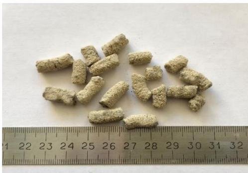
Рисунок 3.3 – Внешний вид гранулированного заполнителя (фракция кварцевого песка  $\leq 0,16$  мм)
