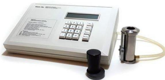
Рисунок 2.7 – Прибор для определения удельной поверхности ПСХ-10а
