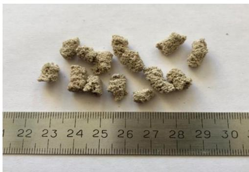
Рисунок 3.5 – Внешний вид гранулированного заполнителя (фракция кварцевого песка  $\leq 0,63$  мм)
