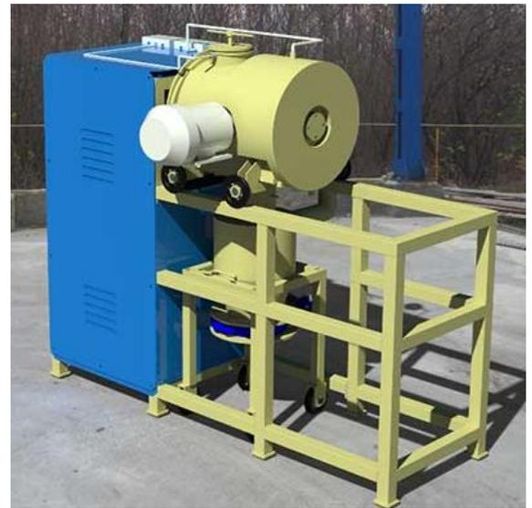
Рисунок 2.10 – Роторная шаровая мельница с принудительным охлаждением РШМ-60-7
