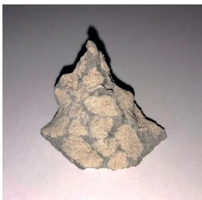
Рисунок 3.7 – Скол образца раствора с ГЗ (фракция песка  $\leq 0,16$  мм)
