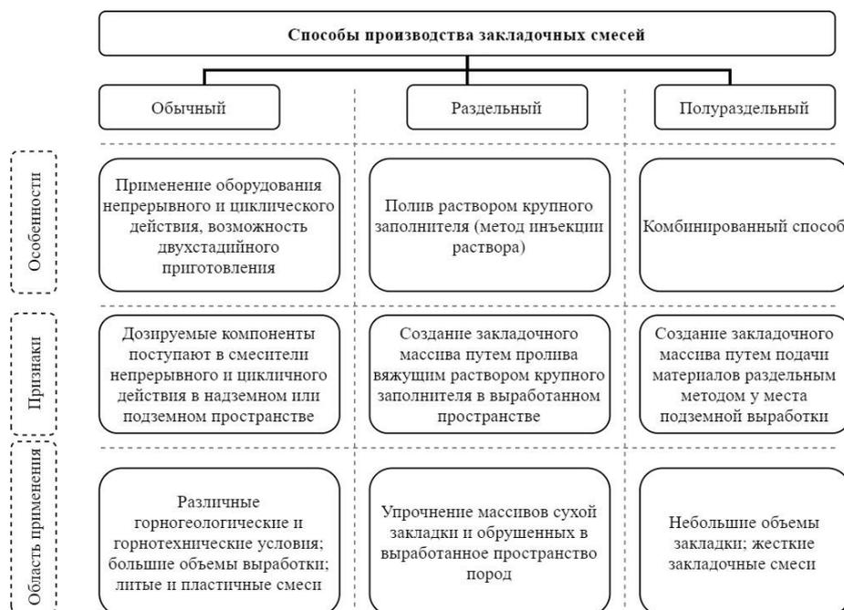
Рисунок 5.11 – Способы производства закладочных смесей
