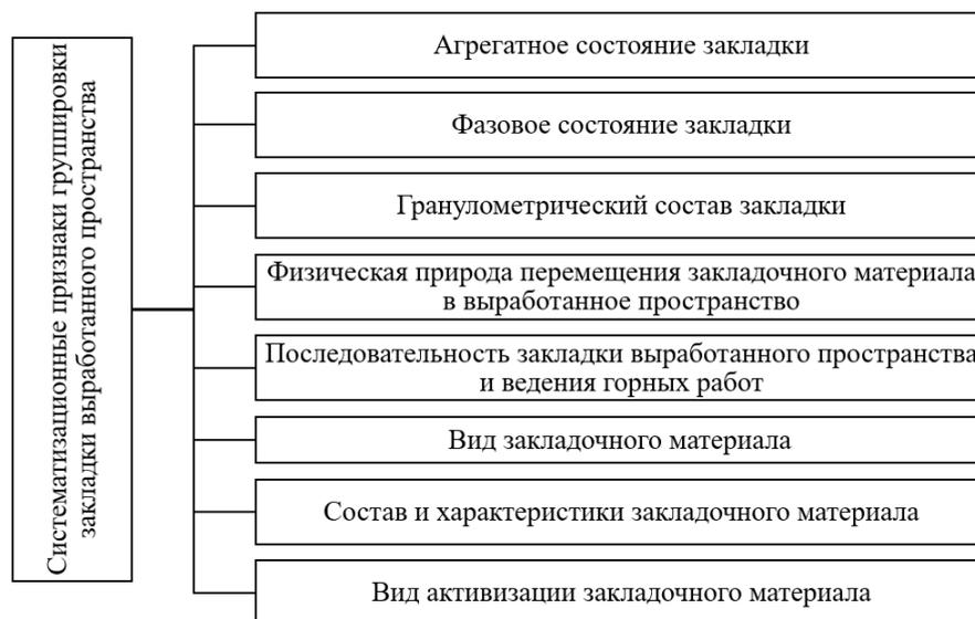
Рисунок 1.1 – Основные систематизационные признаки группирования закладочных массивов в выработанном пространстве
