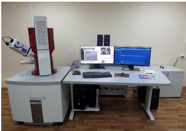
Рисунок 2.5 – Электронный сканирующий микроскоп Tescan MIRA 3 LMU
