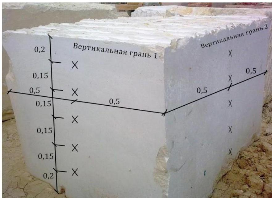
Рисунок 5.13 – Кубический образец закладочного массива
