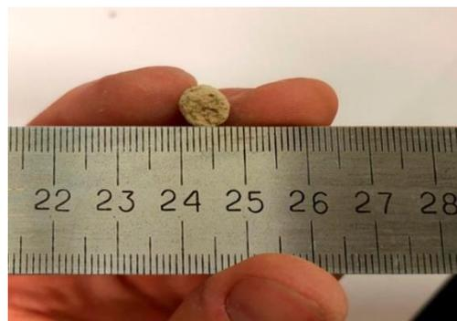
Рисунок 3.6 – Внешний вид гранулированного заполнителя
