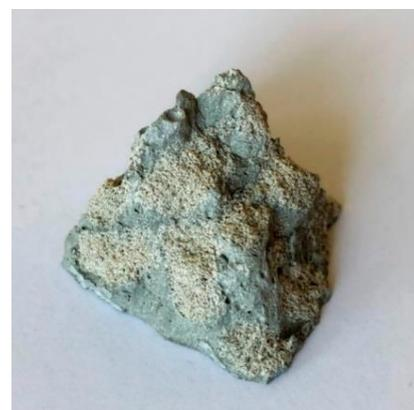
Рисунок 3.9 – Скол образца раствора с ГЗ (фракция  $\leq 0,63$  мм)
