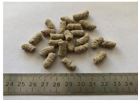
Рисунок 3.4 – Внешний вид гранулированного заполнителя (фракция кварцевого песка  $\leq 0,315$  мм)
