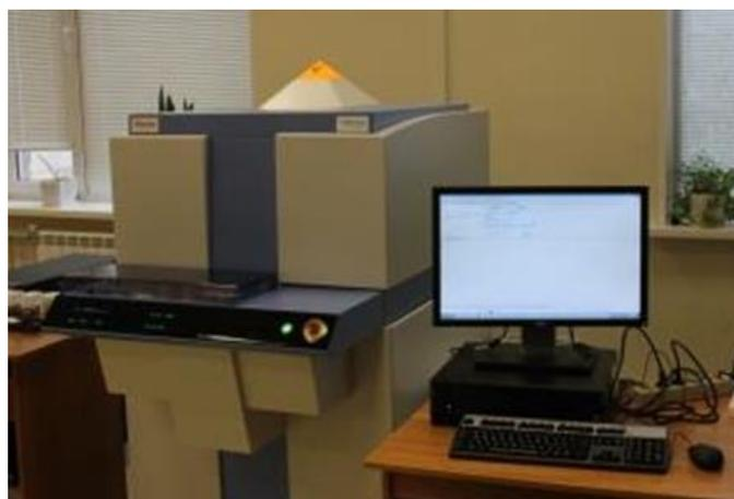
Рисунок 2.4 - Рентгенофлуоресцентный спектрометр серии ARL 9900 WorkStation
