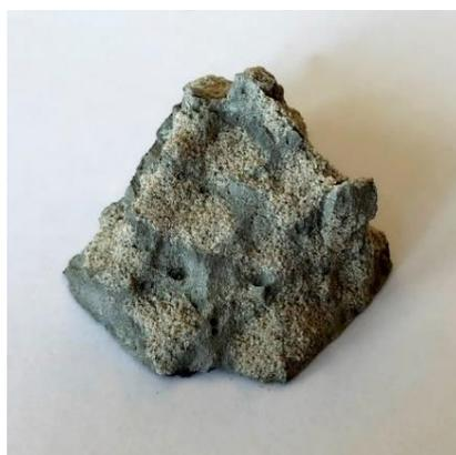
Рисунок 3.8 – Скол образца раствора с ГЗ (фракция песка  $\leq 0,315$  мм)
