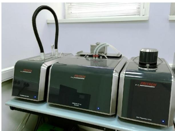
Рисунок 2.3 – Лазерный анализатор размера частиц Analysette 22 NanoTec plus
